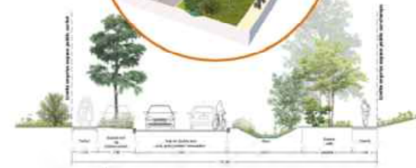
ENTRÉE DE QUARTIER Nord et Ouest VOIE DOUBLE SENS avec piste cyclable «chaussidou» + trottoir séparé Gabarit 18,3m
