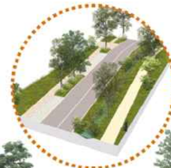
ENTRÉE DE QUARTIER Nord et Ouest VOIE DOUBLE SENS avec piste cyclable «chaussidou» + trottoir séparé Gabarit 18,3m
